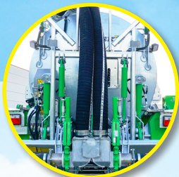
Гидравлическое противокапельное устройство (система TWIST)
